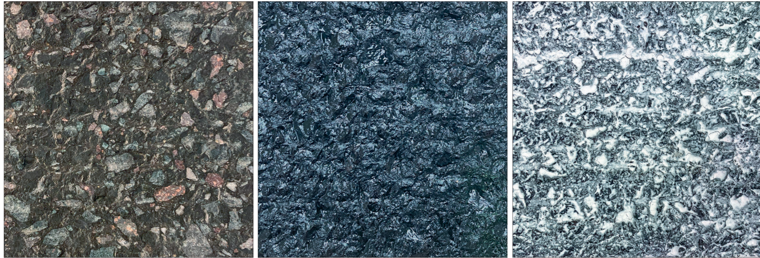
Bild 7 (v.l.n.r): Darstellung der Oberflächen der gefrästen Unterlage im Applikationsprozess. Bild 7 links: Gefräste Oberflächentextur einer Asphaltplatte. Bild 7 mitte: Gefräste Oberflächentextur nach der Applikation von Bitumenemulsion. Bild 7 rechts: Gefräste Oberflächentextur nach der Applikation von Bitumenemulsion und anschließender Applikation von Kalkhydratsuspension.
